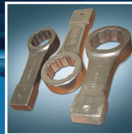
Ключи, изготавливаются из высокопрочного алюминиевого сплава Д16 методом объемной горячей штамповки с последующей термообработкой.
